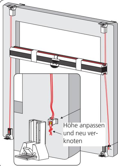
Länge der unteren Spannschnüre der Fenstergröße anpassen, ggf. Kürzen und mit neuem Knoten in der Spannfixierung fixieren. Spannfixierung für die unteren Halter vorsichtig in die Halterungen einführen. Leichte Spannung durch die Fixierung aufbauen und einrasten lassen. Achtung: Rückstellhebelchen dabei mittig zwischen den Schnüren halten. Knoten innenliegend. Beide Seiten gleichmäßig positionieren. Plissee dabei gerade, waagrecht hängend. Keinen Druck oder Zug auf den Feststellhalter ausüben.
