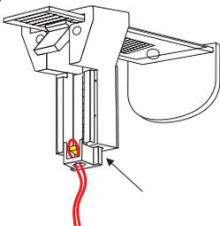
Spannfixierung für die oberen Halter vorsichtig in den Halter einführen und einrasten. Achtung: Rückstellhebelchen dabei mittig zwischen den Schnüren halten. Beide Seiten gleichmäßig positionieren. Plissee dabei gerade, waagrecht hängend. Keinen Druck oder Zug auf den Feststellhalter ausüben.
