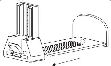
Klemmschiene in Spannhalterung einführen und entsprechend der Fensterfalz oben und unten festklemmen. Genaue Position des Plissees beachten, so dass die Spannschnüre senkrecht verlaufen. Nach richtiger Positionierung mit dem Klebestreifen fixieren.
